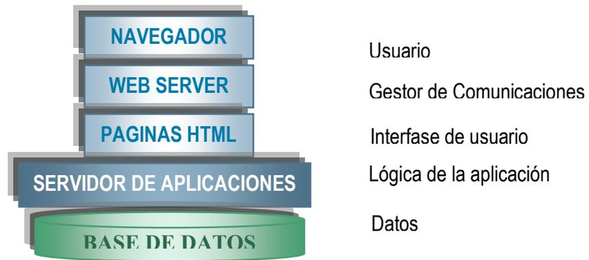
El esquema de configuración a nivel de red es el siguiente:
